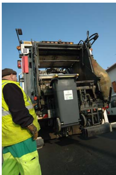
Collecte par benne tasseuse des bacs multimatériaux (couvercle jaune) en porte à porte.
